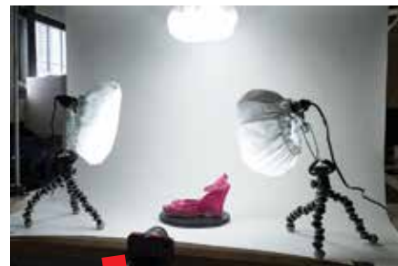
Primjer osvjetljenja kod fotografiranja rotiranjem objekta korištenjem jednog fotoaparata (Instructables. Shooting for Photogrammetry)
